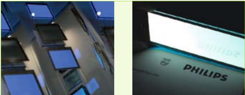
Abb. 7.11 ► Blaue und weiße OLED (Philips); lichterzeugende Fläche etwa 25 cm 2 .
